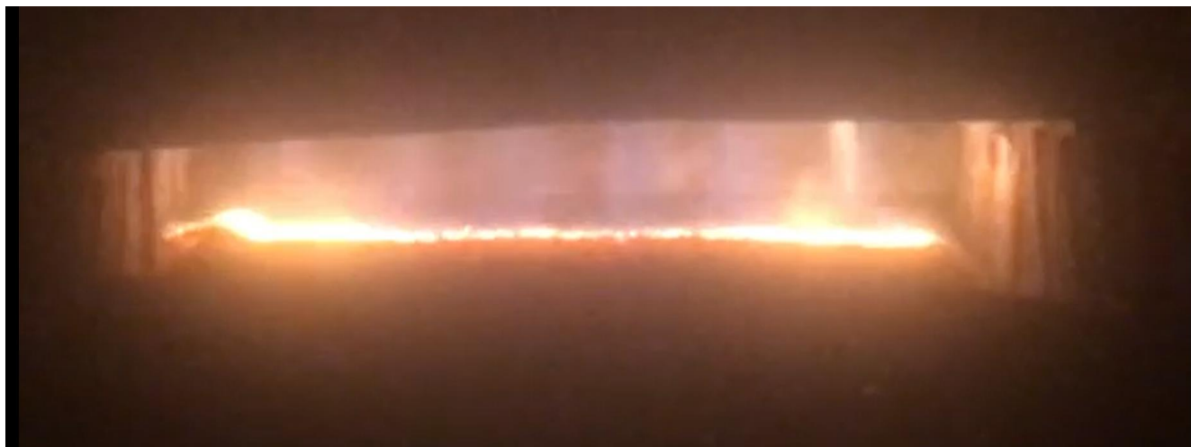
Рис. 4.6 Робота печі КМ-14 на витраті палива 120 м.куб/год.
