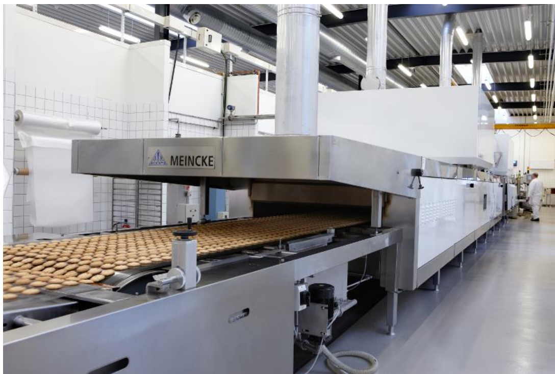
Рис. 3.1 Дослідно-промисловий зразок печі з випікання кексів на фабриці НАAS-MAINСКЕ
