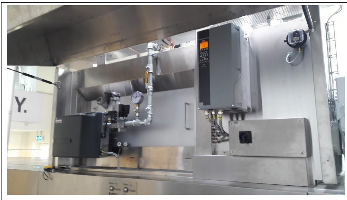
Рис. 2.1 Блок попереднього нагрівання пекарської печі з випікання кексів на дослідному центрі данської фабрики HAAS MEINCKE
