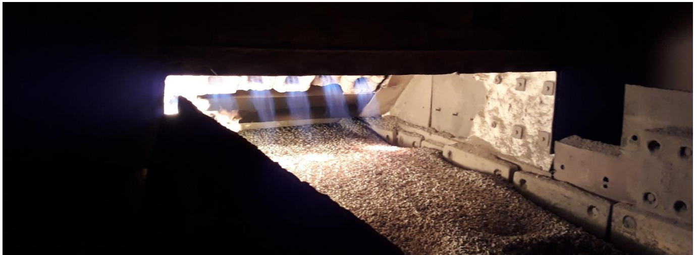
Рис 4.5 Робота пальникових пристроїв СНТ-11 після модернізації машини КМ-14
