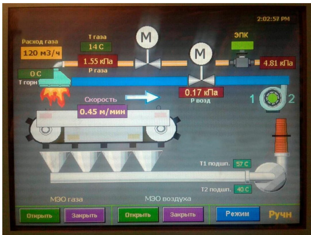
Рис. 4.11 Работа ПП СHT-11 при витраті газу 120 м.куб/год
