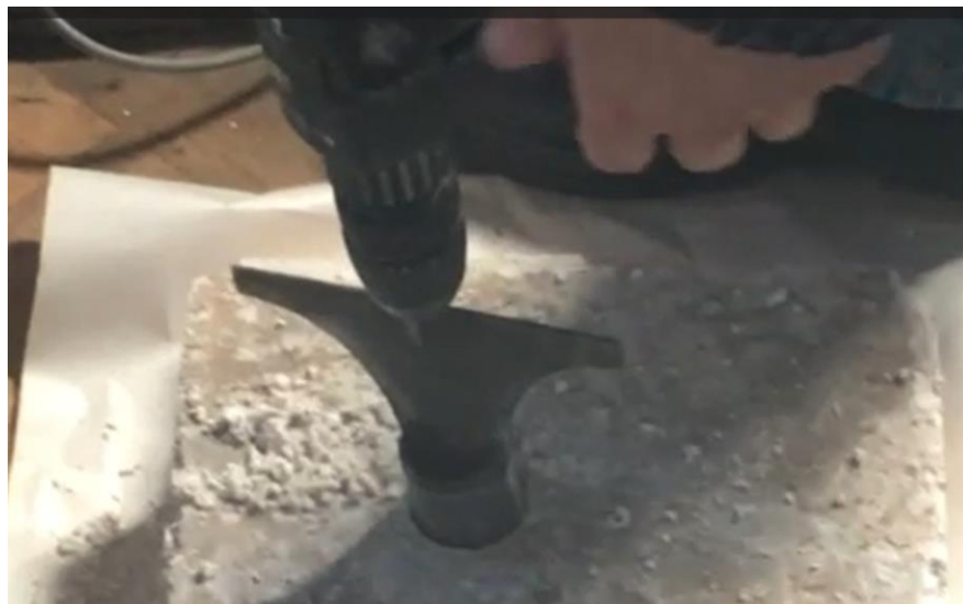
Рис. 6.28 Виготовлення амбразурі за допомогою металевого свердла-лекала.
