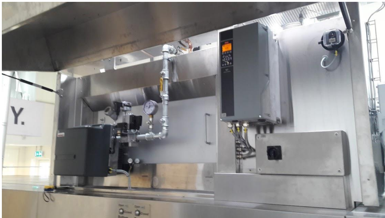
Рис. 3.2 Нагрівальний модуль печі, в якому встановлений пальниковий пристрій вихрового типу
