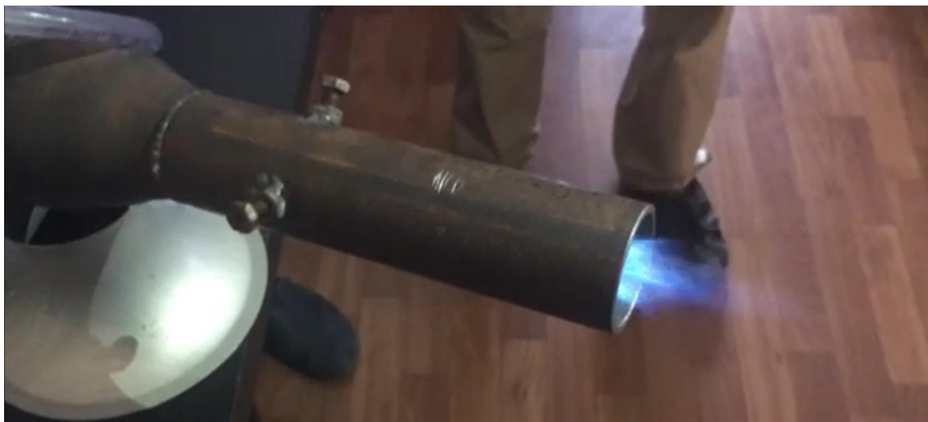
Рис. 6.21 Робота циліндричного пілона з відносним кроком 2,5
