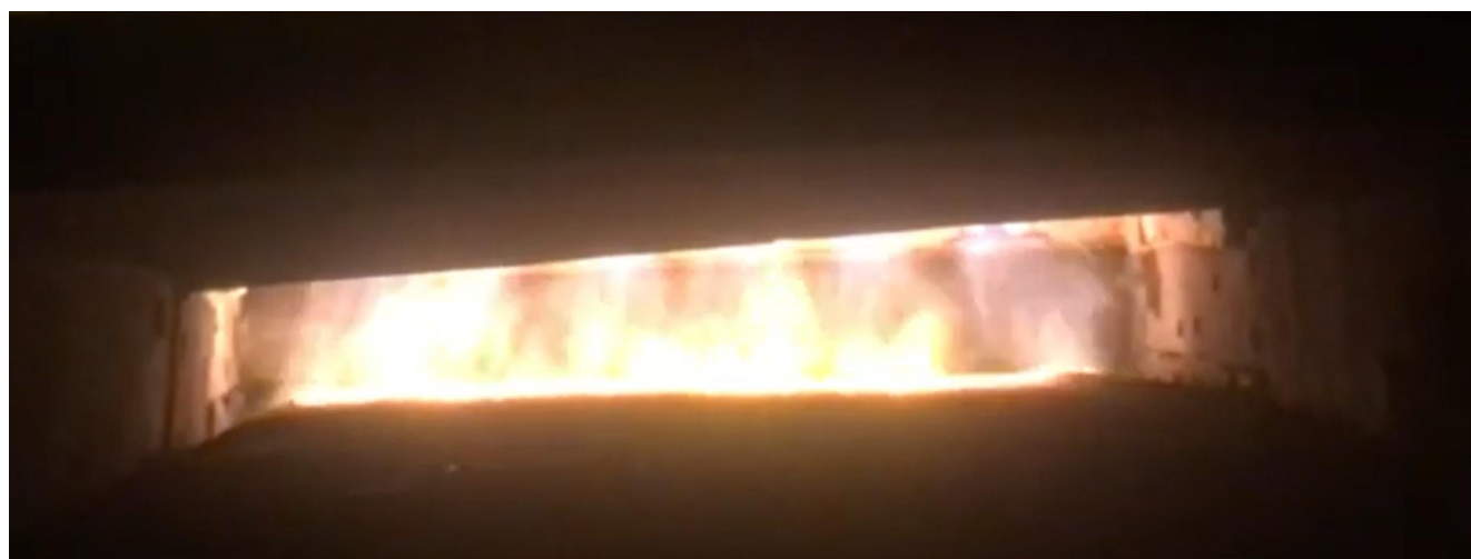
Рис. 4.7 Робота печі КМ-14 на витраті палива 230 м.куб/год.
