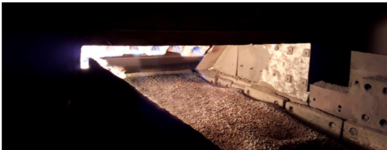
Рис. 4.8 Робота печі КМ-14 на витраті палива 6 м.куб/год.; 1 м.куб/год на один ПП СНТ-11
