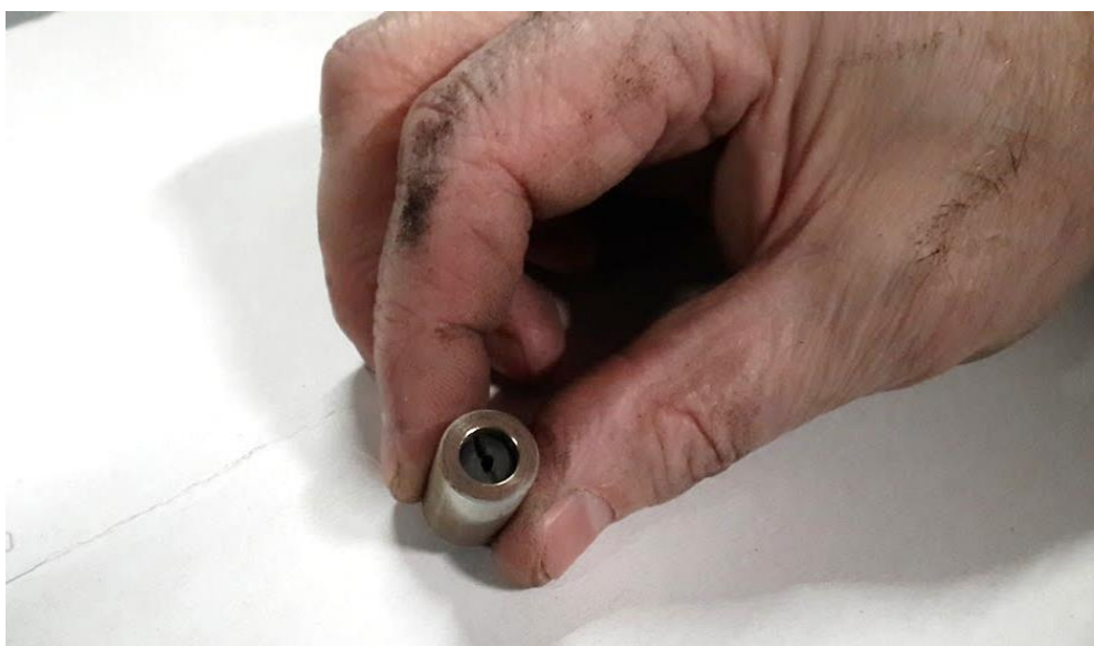
Рис. 5.8 Сажові відкладення на виході з форсунки
