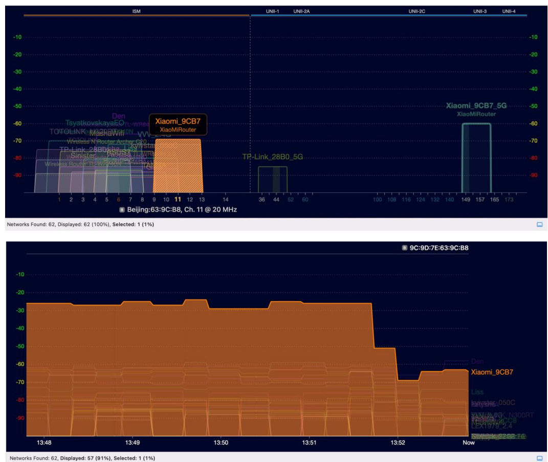
Рисунок 3.7 – дослідження електромагнітної обстановки біля точки доступу
