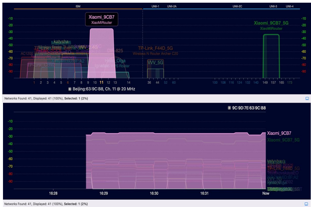
Рисунок 3.8 – дослідження електромагнітної обстановки біля точки доступу
