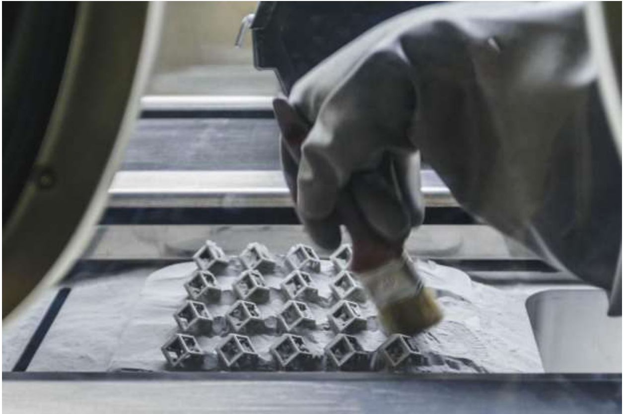
Рис 2.5. Видалення порошку з деталей, виготовлених методом 3D-друку SLM
