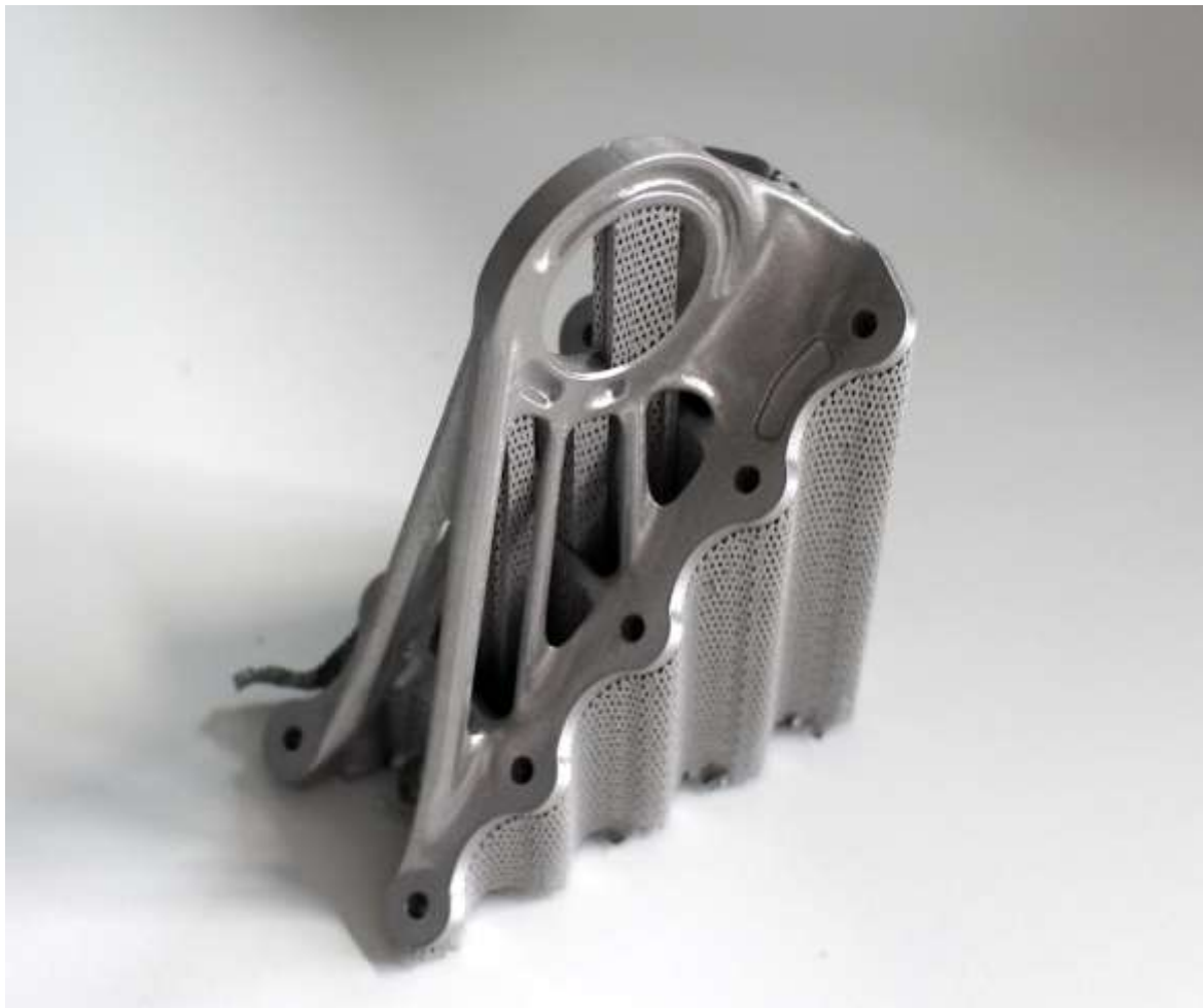
Рис 2.4. Кронштейн перед зняттям з області підтримки, орієнтованої під кутом 45^{\circ}
