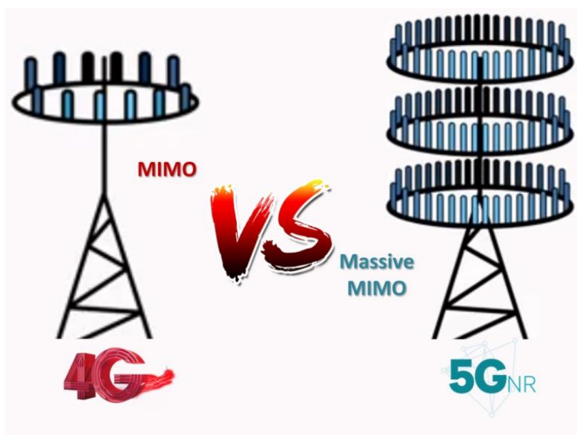
Рис. 3.11 Порівняння кількості антен MIMO та Massive-MIMO
