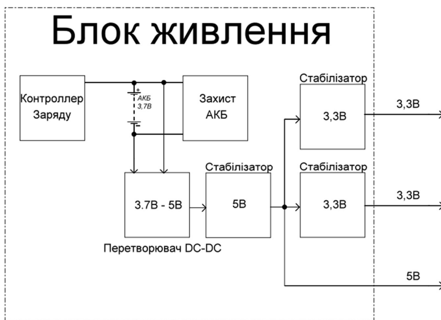
Рисунок 3.2 — Схема електрична структурна. Живлення схеми.
