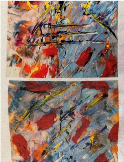
Зразки друку технологією DTG (зліва) та DTF (зправа)
