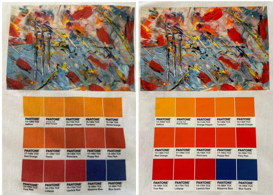
Рисунок 2.7 – Зразки друку технологією DTG (зліва) та DTF (зправа)
