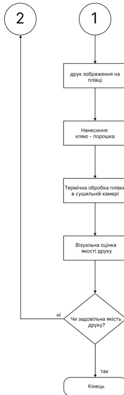
Рисунок 3.7 – Алгоритм виконання операцій DTF друку зображення на проміжному носії – плівці (закінчення)
