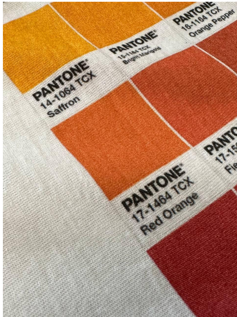
Рисунок 2.10 – приклад відтворення технологією DTG дрібних деталей на зображенні.
