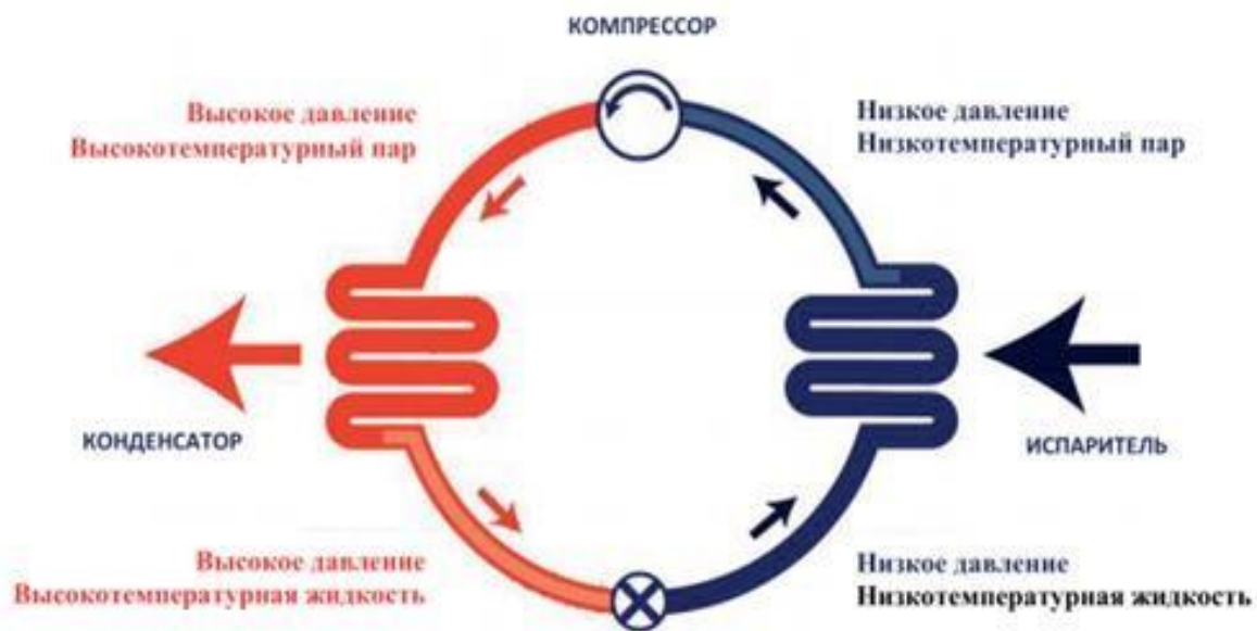
Рисунок 1.1 – Принцип роботи теплового насоса
