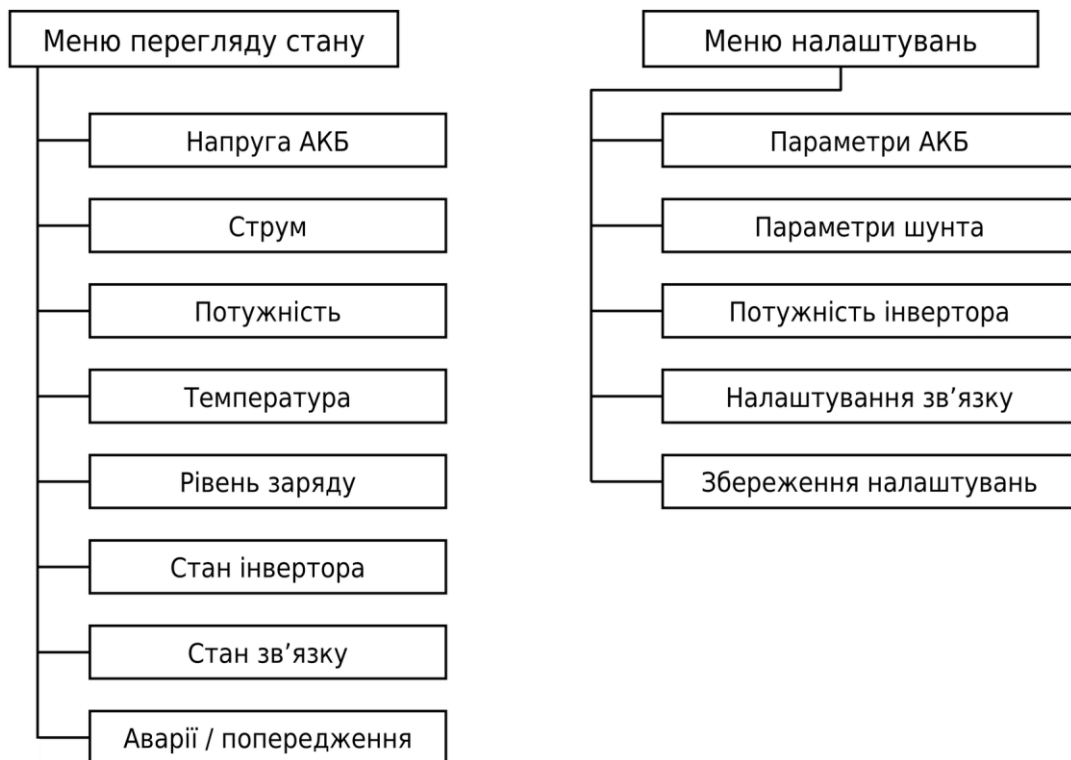
Рисунок 3.7. Структура меню користувача контролера
