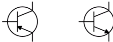
Рис. 2. Позначення БТ на електричних схемах: а – р-п-р-типу; б – п-р-п-типу
