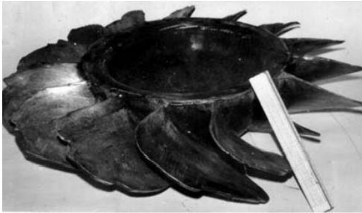
Рис.1.18. Штамповане колесо із широкохордними лопатками.
