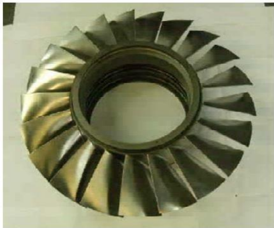
Рис.1.13. Осьове моноколесо, яке виготовлене високошвидкісним фрезеруванням.
