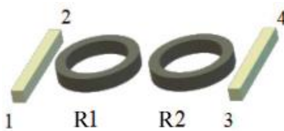
Рисунок 2.5 - Схема 2-резонаторного фільтру, модель якого пропонується
