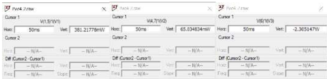
Рис.4.12. Результати вимірювання потужностей джерел живлення напруги V1, V2, V3 схеми на рис.4.11
