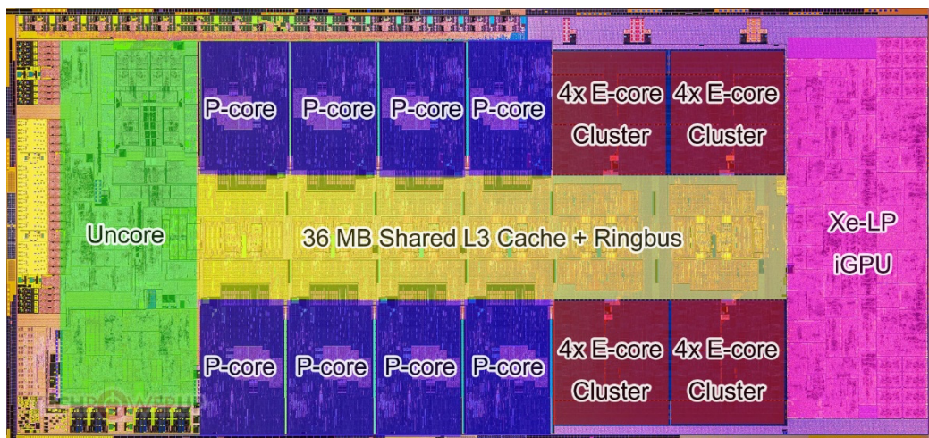
Рисунок 2.1 – Структура процесора Intel Core i9-14900KS
