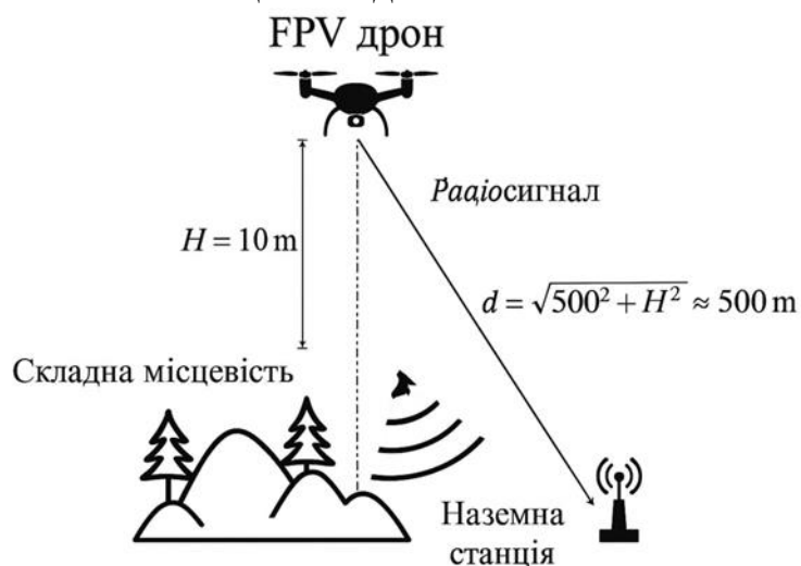
Рисунок 1. Схема зв'язку між FPV дроном і наземною станцією
