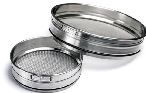
Рис. 3. Сита для просіювання ґрунту
