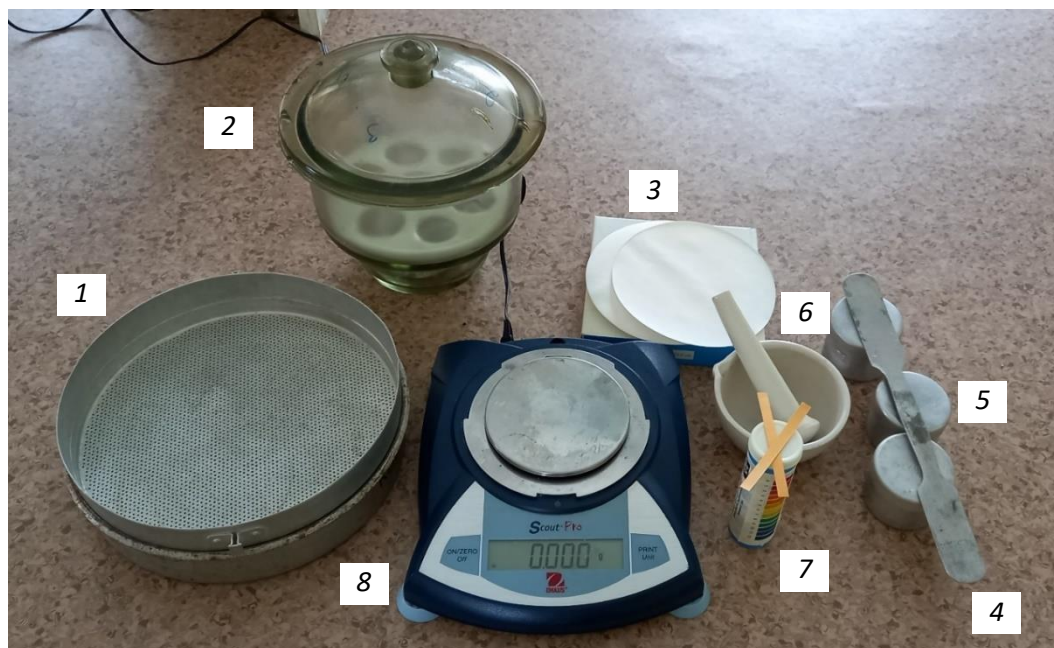
Рис. 4. Фото обладнання для лабораторної роботи: 1 – сито; 2 – ексикатор; 3 – фільтрувальний папір; 4 – шпатель; 5 – металеві бюкси; 6 – ступка; 7 – універсальний індикаторний папір; 8 – ваги
