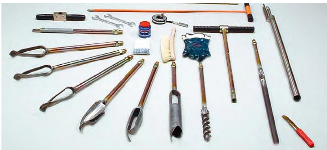
Рис. 2. Бури для відбору проб ґрунту
