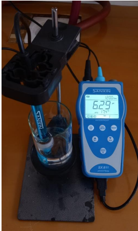
Рис. 7. Зовнішній вигляд рН-метра Sanxin
