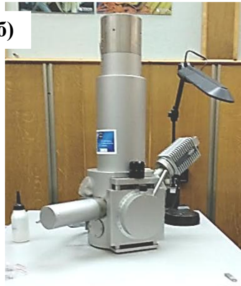
а – Металографічний мікроскоп iScore IS.1053-PLMi; б – СЕМ Tescan Vega 3 Рисунок 2.10 – Зовнішній вигляд приладів для дослідження мікроструктури [17]
