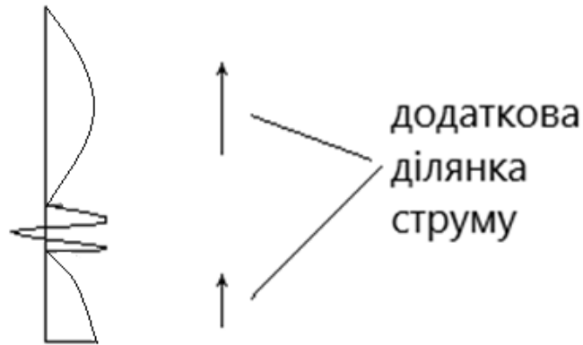
Рисунок 3.2- Антена із загальною довжиною струму одного напрямку
