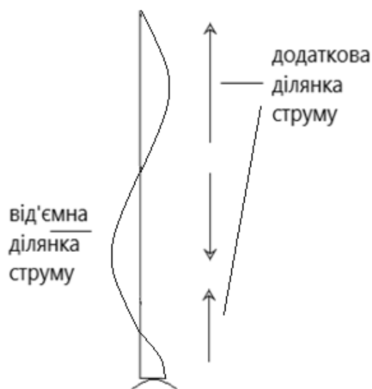
Рисунок 3.1- Розподіл струму в колінеарній антені
