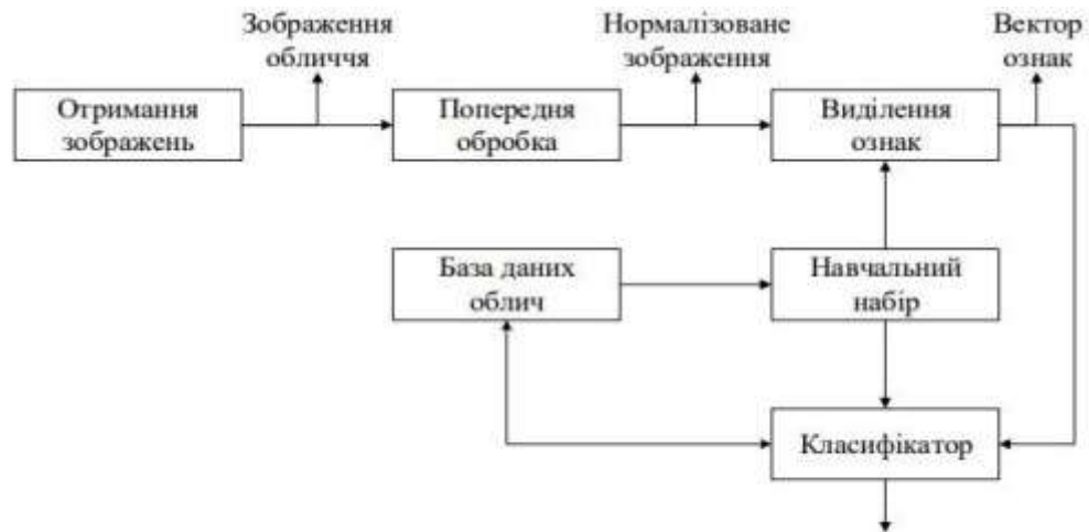
Рис. 1. Загальний процес обробки зображення обличчя при розпізнаванні
