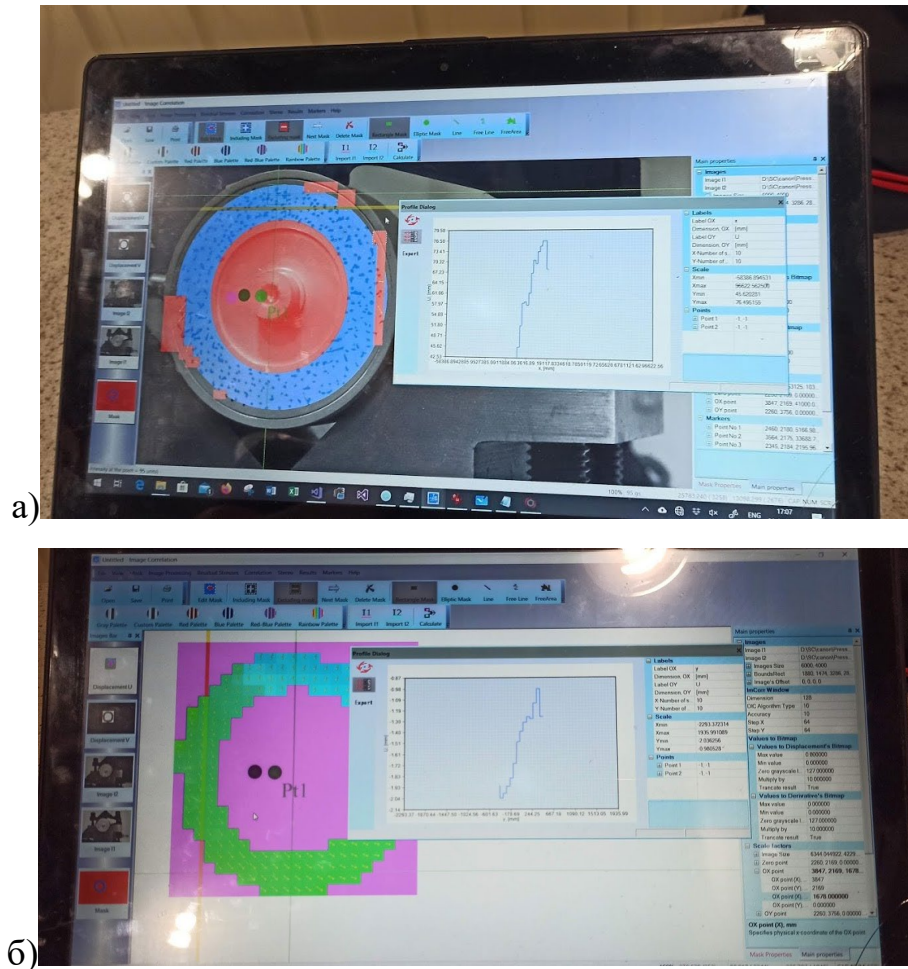
Рисунок 4.14 - Обробка отриманих фотографічних зображень (а) та розрахунок залишкових зварювальних деформацій (б) за допомогою програмного продукту визначення компонент напружено-деформованого стану виробу DIC методом
