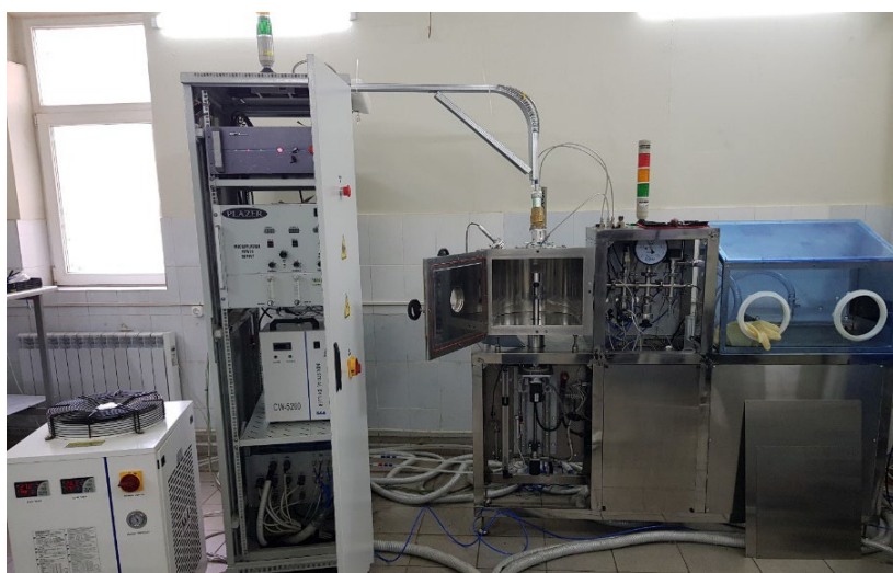
Рисунок 5.11 - Зовнішній вигляд дослідно-промислового комплексу зварювання тонкостінних виробів космічної галузі з легких високоміцних сплавів
