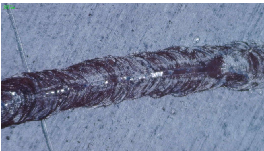
Рисунок 5.4 - Зовнішній вигляд ділянки замикання кільцевого шва при лазерному зварюванні
