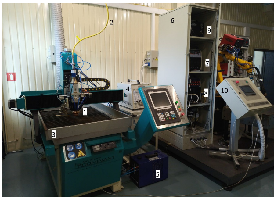
Рисунок 2.4 - Загальний вигляд лабораторного стану щодо попередніх експериментів по зварюванню зразків легких сплавів: 1 – зварювальна головка; 2 – лазерне оптичне волокно; 3 – трикоординатний маніпулятор; 4 – система газопідготовки; 5 – блок автономного охолодження зварювальної головки; 6 – силова шафа; 7 – джерело живлення мікроплазмової дуги; 8 – блок автономного охолодження мікроплазмового джерела живлення; 9 – плазмовий модуль; 10 – пульт керування комплексом.
