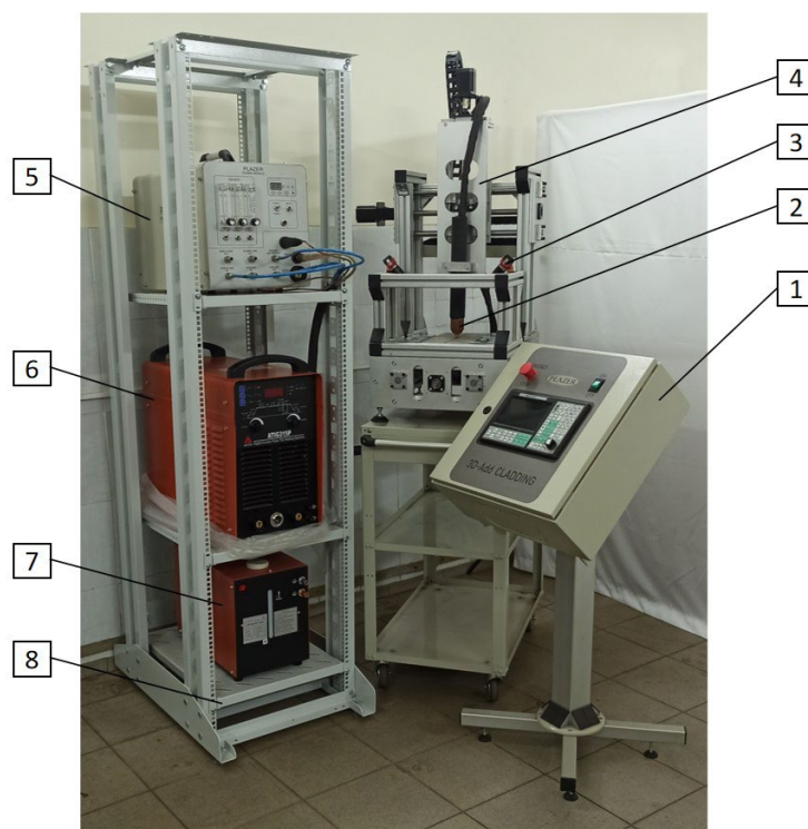
Рисунок 5.5 - Загальний вигляд комплексу апаратури для зварювання та визначення залишкових деформацій DIC методом: 1 – пульт управління маніпулятором; 2 – змінний зварювальний пальник; 3 – камери високої розрізняльної здатності (2 шт.); 4 – маніпулятор для виконання процесу зварювання; 5 – плазмовий модуль; 6 – спеціалізоване джерело живлення для мікроплазмового зварювання; 7 – блок охолодження зварювального пальника; 8 – стійка устаткування
