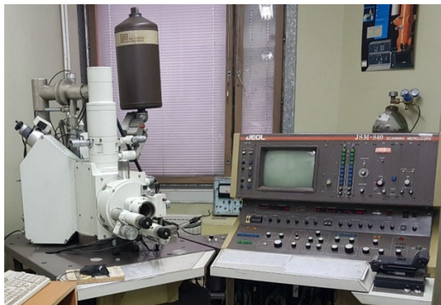
Рисунок 2.9 - Зовнішній вигляд аналітичного растрового електронного мікроскопа JSM-840
