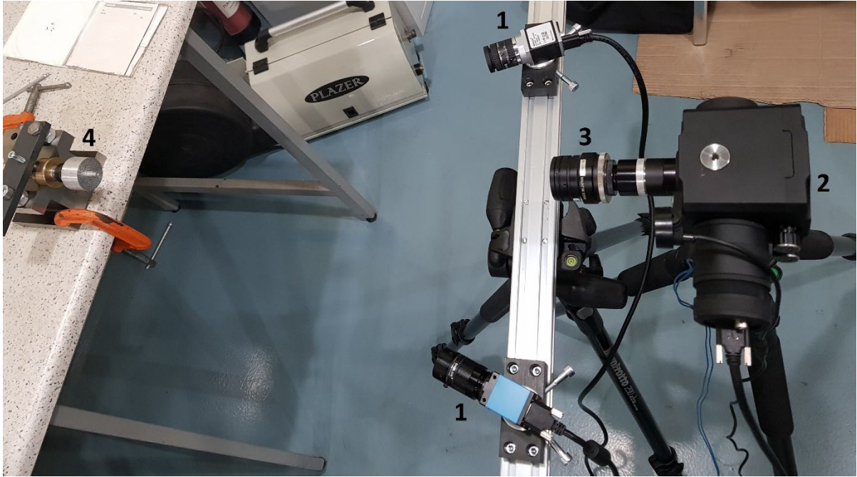
Рисунок 4.2 - Лабораторний стенд для спекл-кореляційних вимірювань: 1 – цифрові фотокамери, 2 – лазерне джерело освітлення, 3 – об'єктив, 4 – досліджуваний об'єкт
