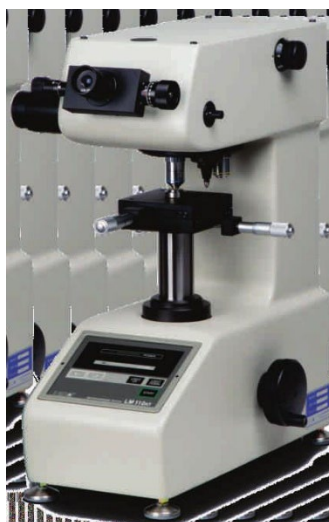
Рисунок 2.10 - Зовнішній вигляд мікротвердоміра LM-400 (серія LECO)
