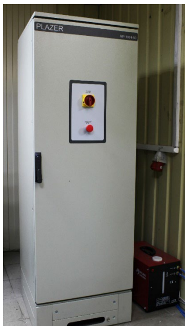
Рисунок 5.16 - Зовнішній вигляд лицьової панелі прототипу джерела живлення (а) та всієї шафи управління в єдиному блоці з джерелом живлення (б, в) прототипу обладнання лазерного зварювання із супутнім мікроплазмовим підігрівом
