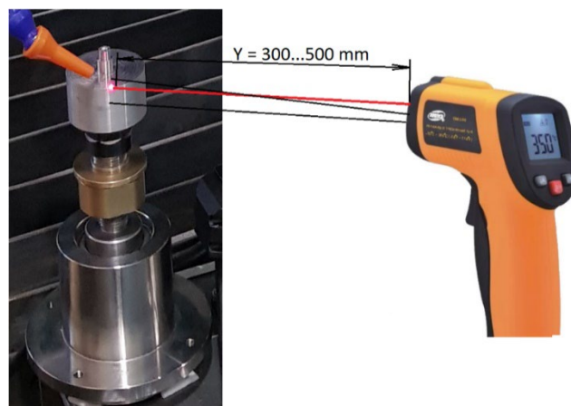
Рисунок 2.7 - Схема вимірювання температури нагріву зразків після зварювання за допомогою ручного інфрачервоного пірометра (червона лінія візуалізує лазерний приціл)
