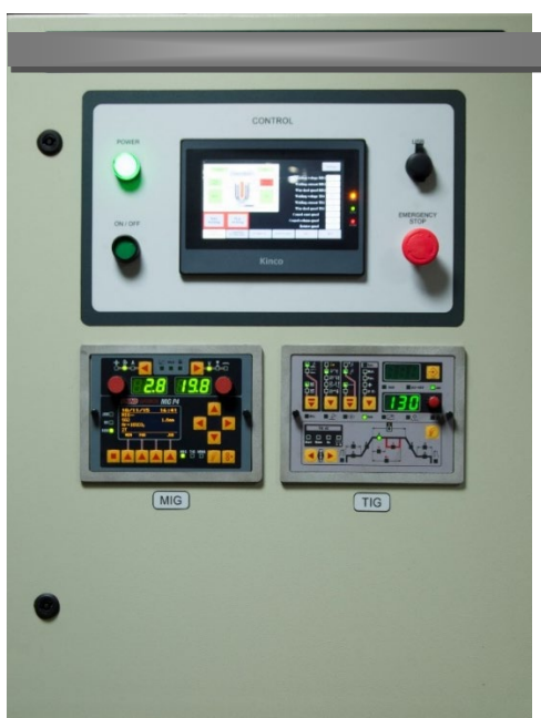
Рисунок 5.15 - Зовнішній вигляд лицьової панелі прототипу системи управління обладнання для зварювання тонкостінних виробів космічної галузі з легких високоміцних сплавів
