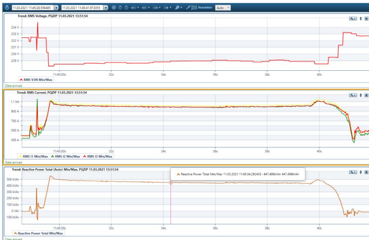
Рисунок 3.9 - Графік RMS напруги та струму, реактивної потужності протягом 40 секунд 11.03.2021
