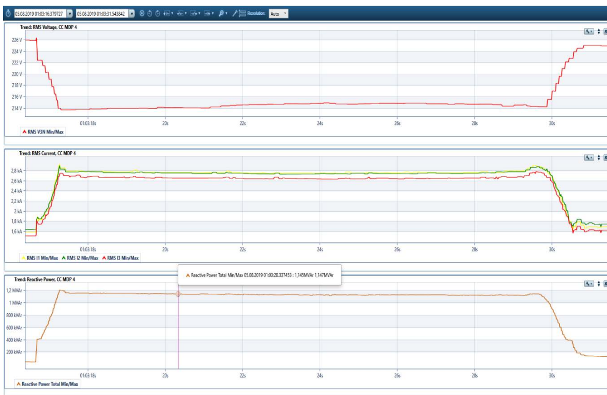
Рисунок 3.5 - Графік RMS напруги та струму, реактивної потужності протягом 30 секунд 05.08.2019
