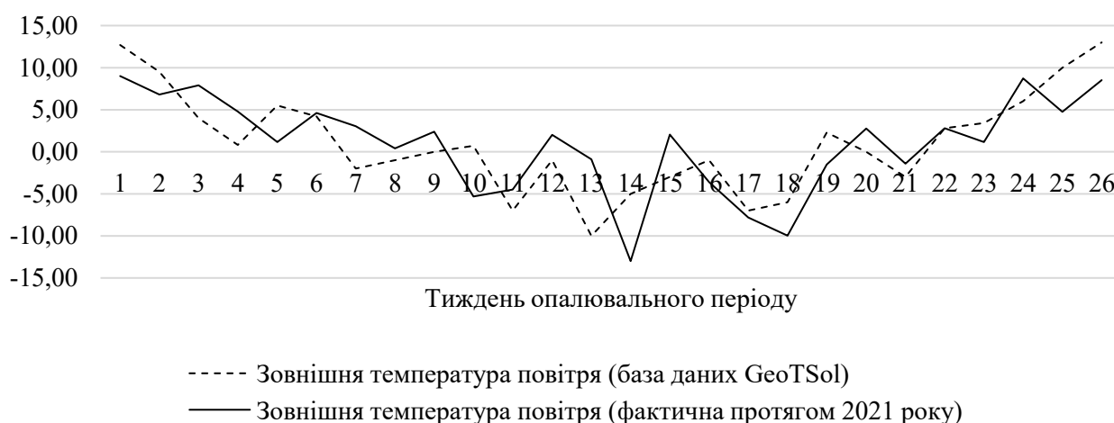
Рисунок 3.4.5. Динаміка температури зовнішнього повітря протягом опалювального сезону бази даних GEOTSol та фактичної температури
