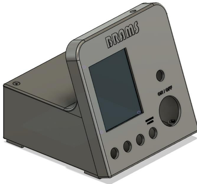
Рисунок 5.1 – Корпус док-станції без елементів керування
