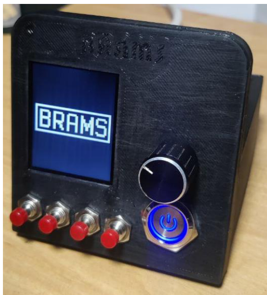
Рисунок 5.5 – Реалізована док-станція системи розумного будинку
