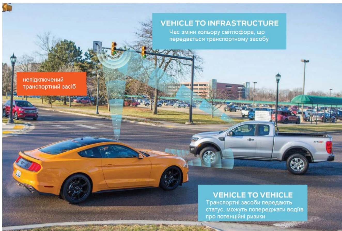
Рисунок 3.3 – Безперебійна система на основі блокчейн-технології, що допомагає автомобілям домовлятися про право проїзду перехресть для забезпечення ефективності та безпеки руху транспорту
