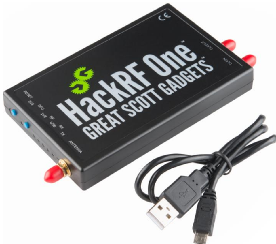
Рисунок 2.9 – SRD приймач HackRF One
