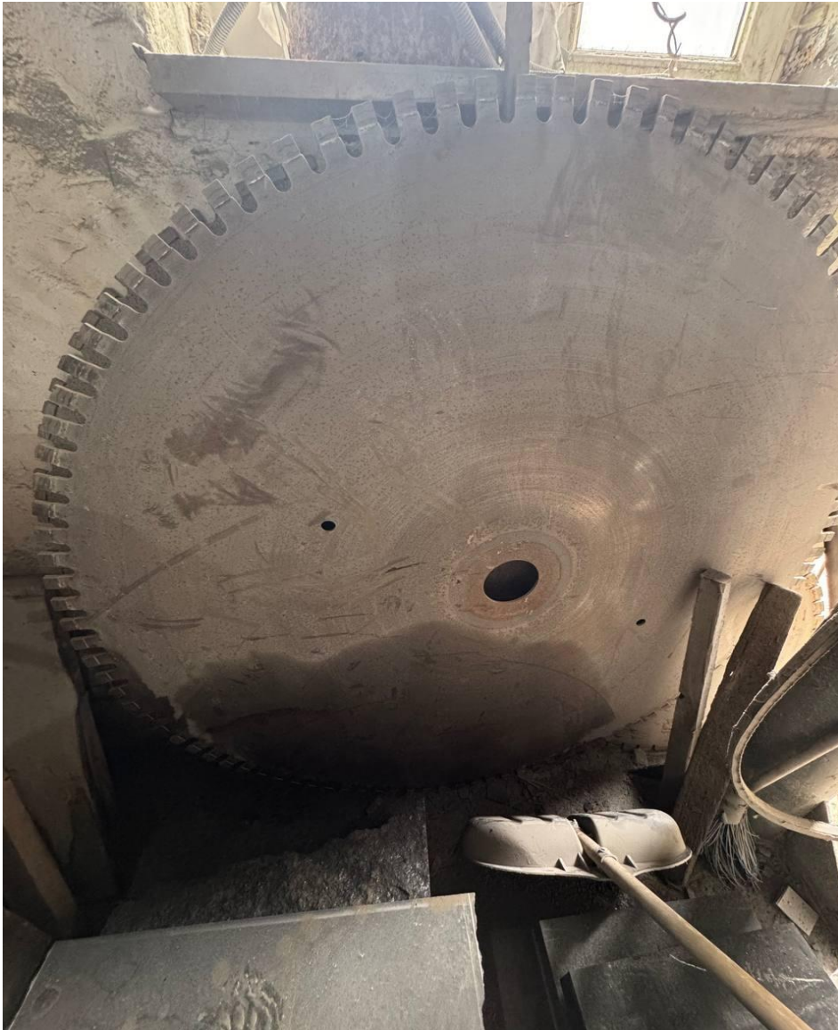
Рисунок 1.4 – Дисконна фреза та алмазні напайки виробничого аналога
