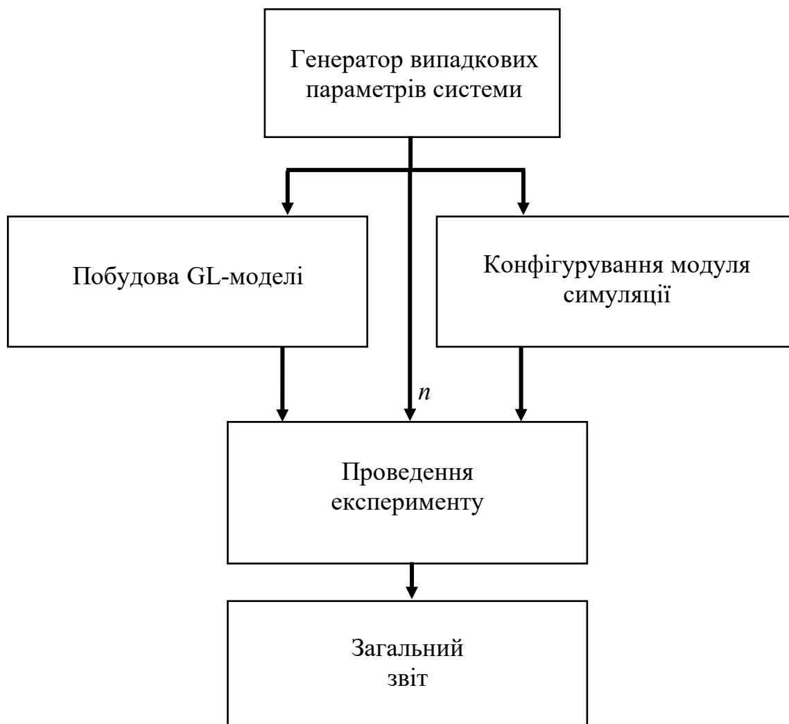
Рисунок 5 - Схема проведення експериментів із випадковими параметрами ВБС
