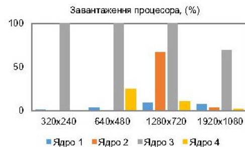
Рис. 4 Середній відсоток завантаження процесорних ядер передавача при передаванні кадрів різної роздільної здатності
