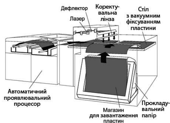
Рис. 5.2. Формовивідний пристрій з площинним записом форм
