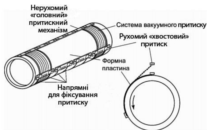
Рис. 5.3. Система кріплення пластин на барабані
