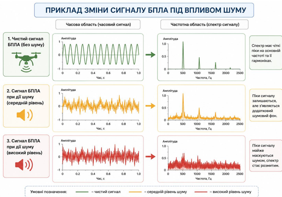
Рисунок 1.4 — Зміни сигналу БПЛА під впливом шуму
