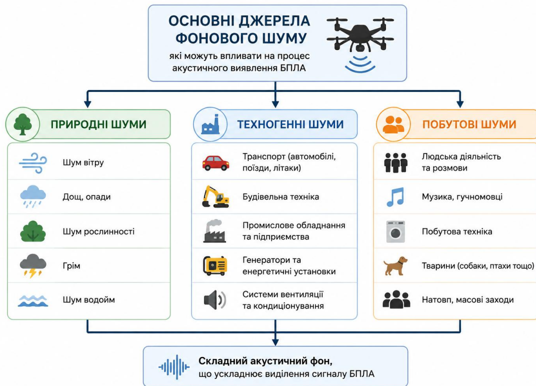
Рисунок 1.2 — Основні джерела фонових шумів, які можуть впливати на процес акустичного виявлення БПЛА
