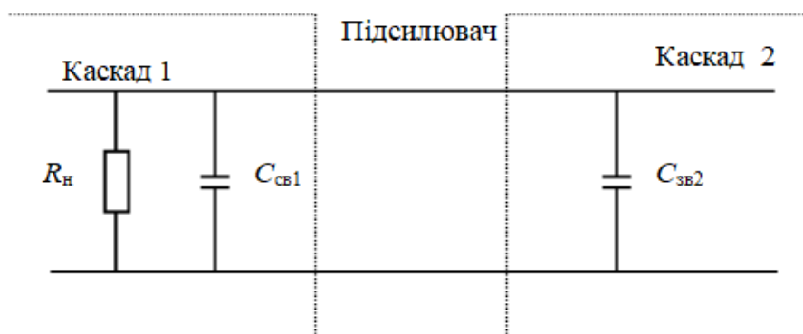
Рис.3.21. Вплив небажаних ємностей на вихід каскаду 1 підсилювача
