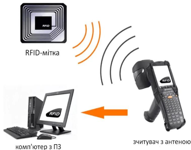
Рисунок 1.2 – Процес передачі даних за допомогою RFID-мітки [30]
