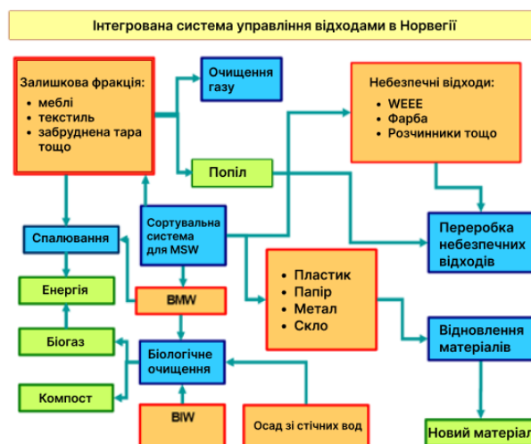
Рис. 2.5. Система сортування та переробки відходів у Королівстві Норвегія [69]
