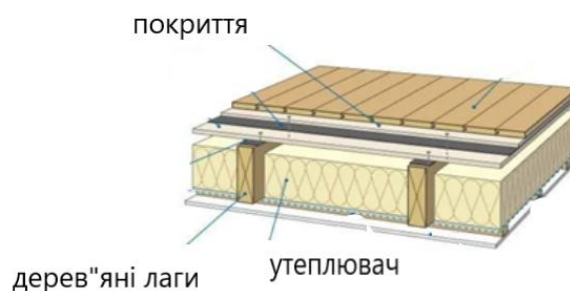
Рисунок 3.4 – Утеплення горищного перекриття
