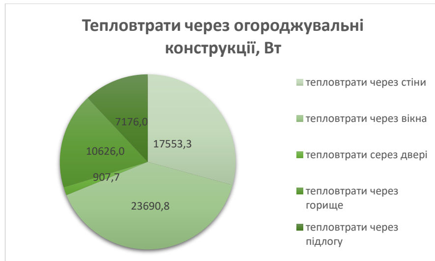
Рисунок 3.1-Тепловтрати через огорожувальні конструкції
