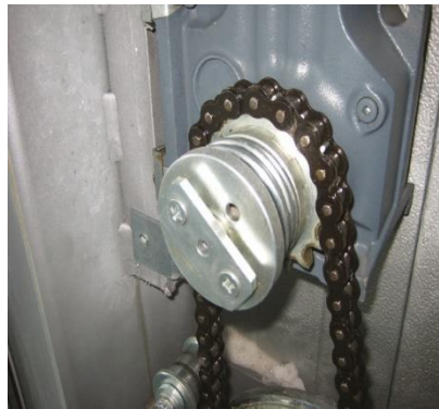
Рис. 1.15 Ланцюгова передача приводу воріт
