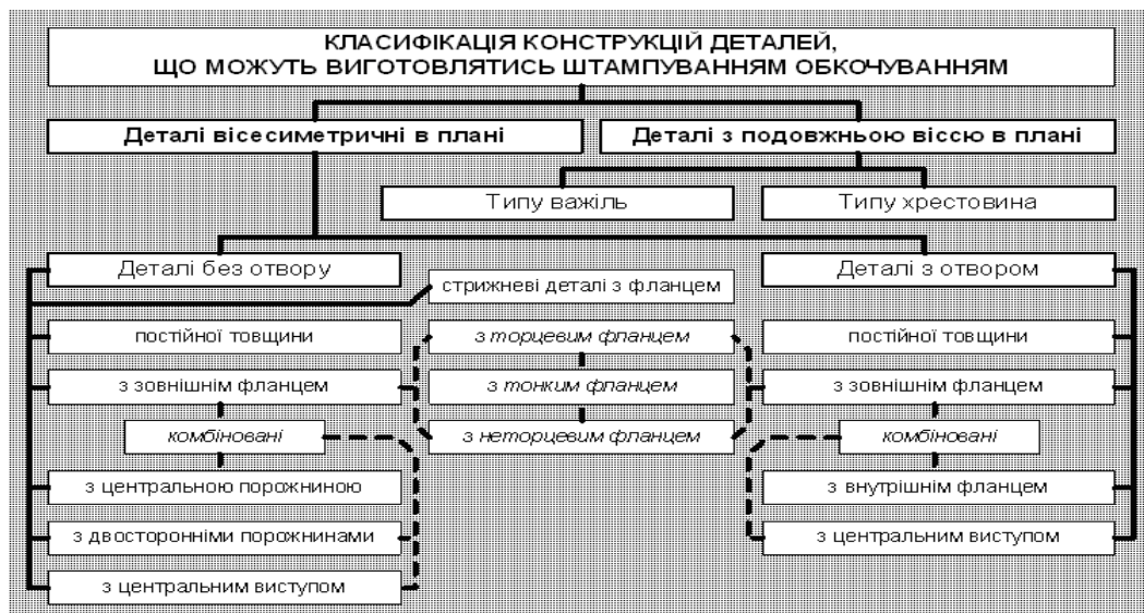
Рис. 1.7. Класифікація деталей за формою, що можуть ефективно виготовлятися [10]
