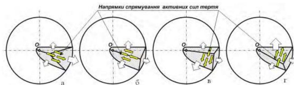
Рис. 1.11. Напрямки спрямування активних сил тертя при обточуванні за годинниковою стрілкою: а – у радіальному напрямку від центру; б – у радіальному напрямку до центру; в – у тангенціальному напрямку, в напрямку обточування; г – у тангенціальному напрямку, напрямку протилежному обточуванню
