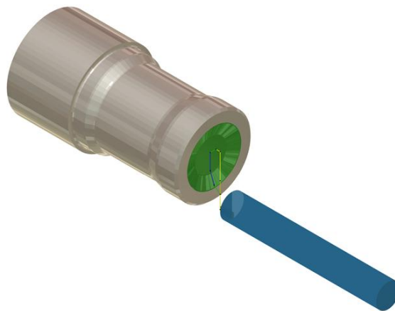
Рисунок 3.9 – Тривимірне зображення операції точіння торцевої канавки
