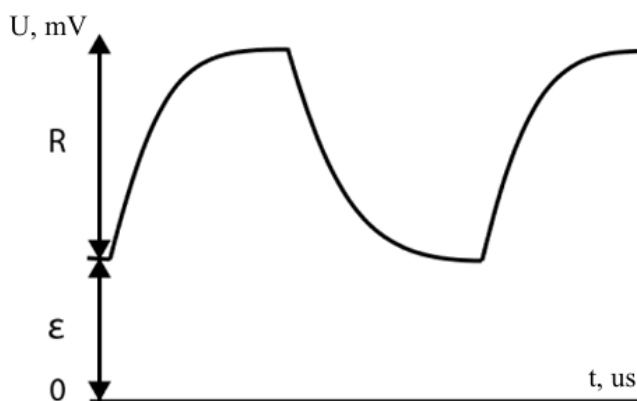
Рисунок 3.25 – Сигнал з фотоприймального модуля оптоелектронної системи
