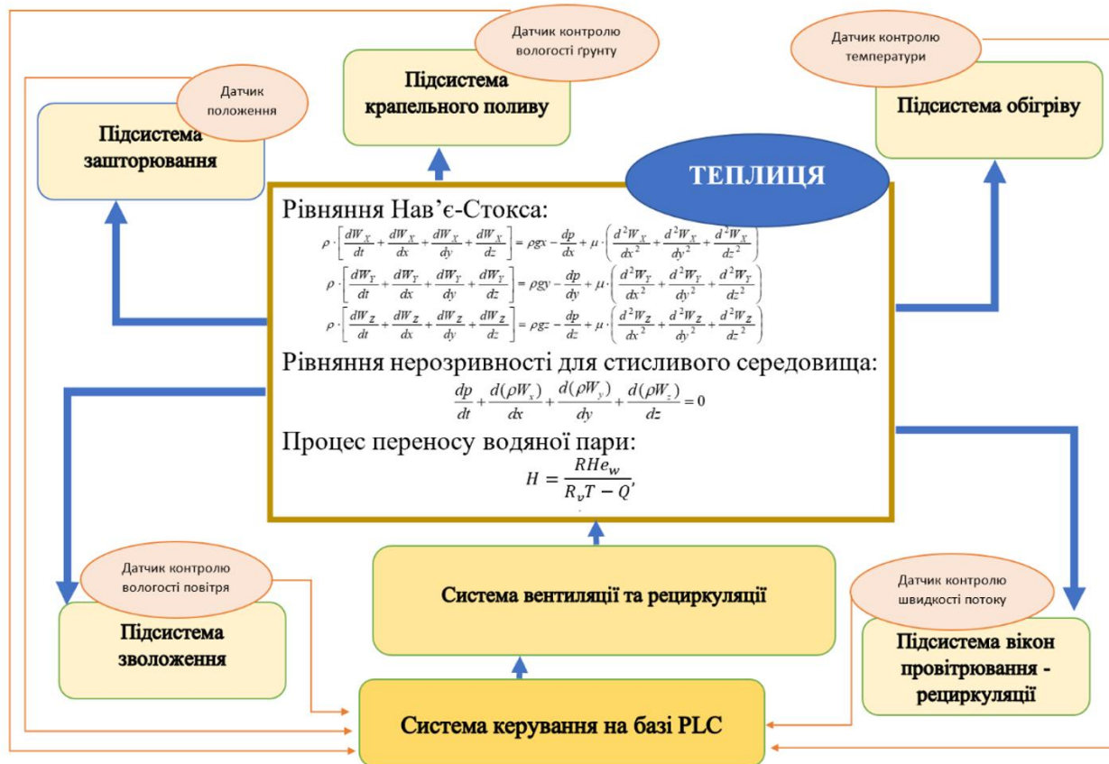
Рис. 2.4. Структура мехатронної системи з моделлю теплиці[19,32,33]
