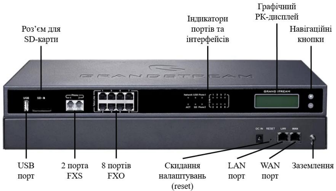
Рисунок 2.6. Інтерфейси та світлодіодні індикатори IP АТС Grandstream серії UCM6208
