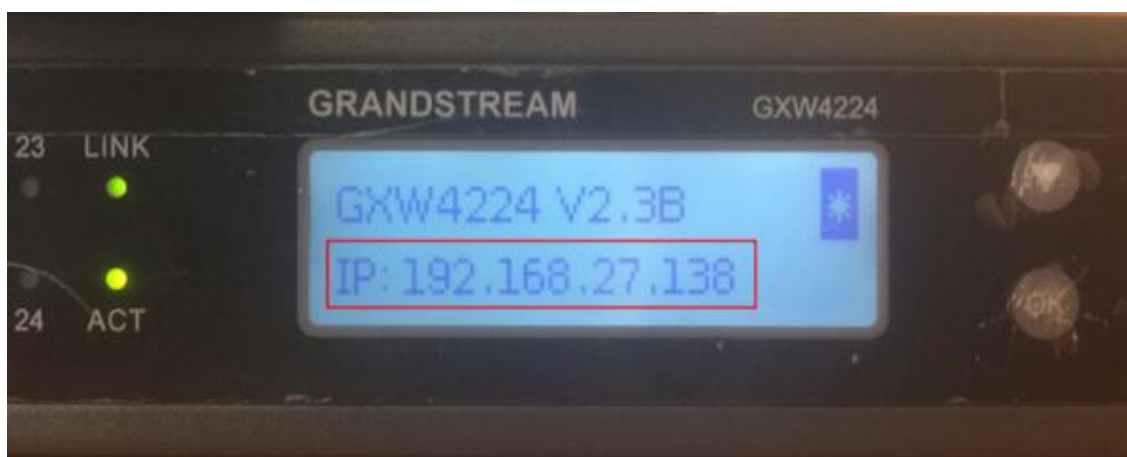
Рисунок 4.18. Розташування IP-адреси на дисплеї шлюза
