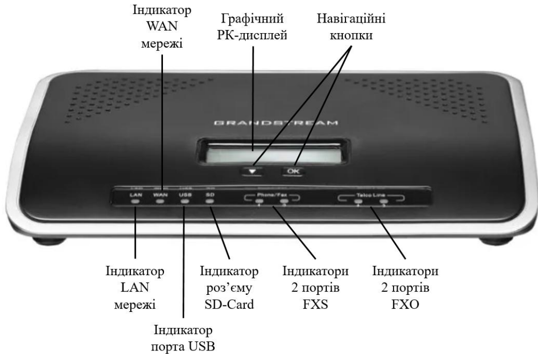
Рисунок 2.2. Світлодіодні індикатори IP ATC Grandstream серії UCM6202
