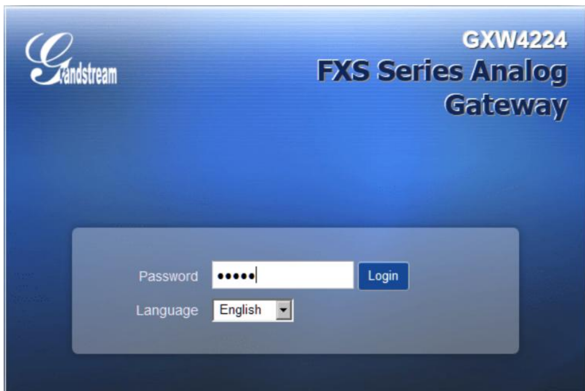
Рисунок 4.19. Сторінка входу до налаштувань VoIP-шлюза GXW4224
