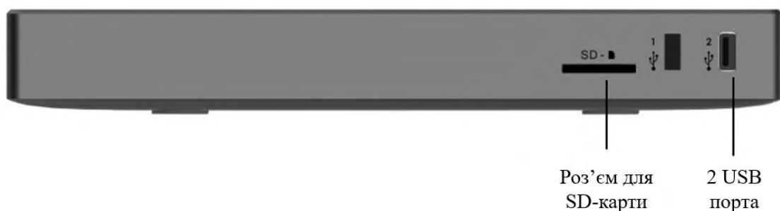
Рисунок 2.12. Інтерфейси IP АТС Grandstream серії UCM6302
