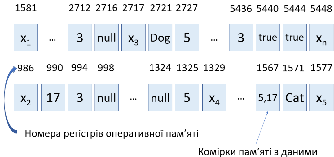
Рисунок 2.2 – Умовний приклад комірок пам'яті з довільно розміщеними даними
