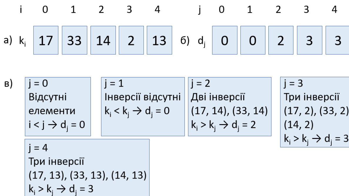
Рисунок 6.1 – Приклад визначення вектору інверсій перестановки П: а) перестановка П; б) вектор інверсій перестановки П; в) визначення інверсій
