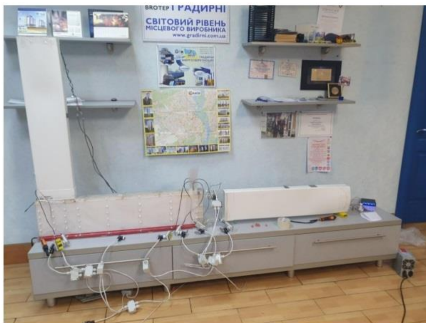
Рис. 1.19 – Фото експериментальної установки для дослідження тепло- і масообміну в елементарній комірці по М-циклу за новою схемою [14]
