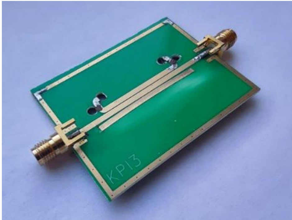
Рис. 1.4 — Конструктивне виконання лабораторного прототипу планарного НВЧ-сенсора (серія КРІЗ)
