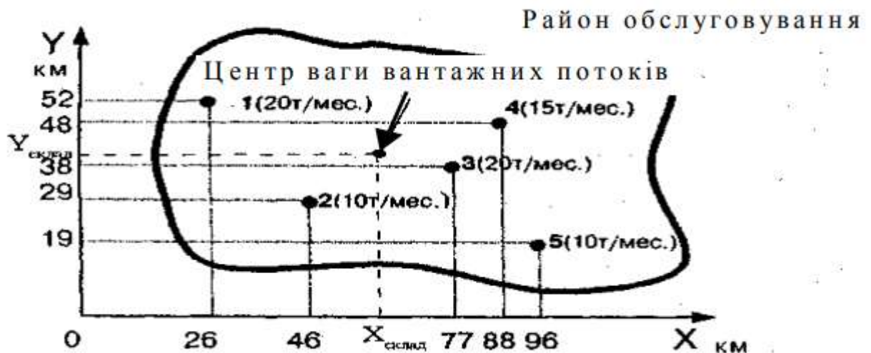
Рисунок 7 - Визначення місця розташування складу методом пошуку центра ваги вантажних потоків (у дужках поруч із номером магазину зазначено його вантажообіг)
