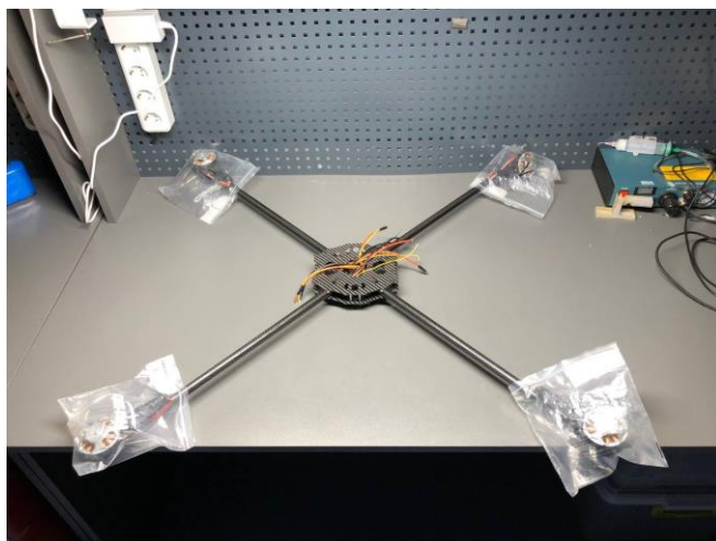
Рисунок 2.33 Закриття моторів від пилу та металевих мікрочастинок зіп пакетами
