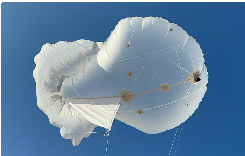
Рисунок 1.27 Аеростат “Аеробавовна”, українського виробництва, призначений для ретрансляції зв’язку багатьох безпілотних систем [15]
