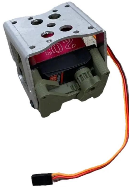
Рисунок 2.15 Система скиду, яка витримує навантаження 3кг
