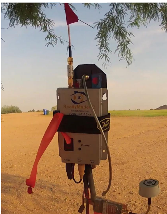
Рисунок 1.20 Наземний ретранслятор на прийом відеосигналу на частоті 1.2 Ghz та передачу на частоті 5.8 Ghz
