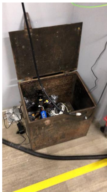
Рисунок 3.3 Під'єднаний коаксіальний кабель до приймача FPV дрона в екранованому ящику
