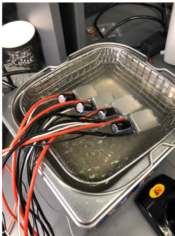
Рисунок 2.23 Змиття залишків пайки на регуляторах в ультразвуковій ванночці
