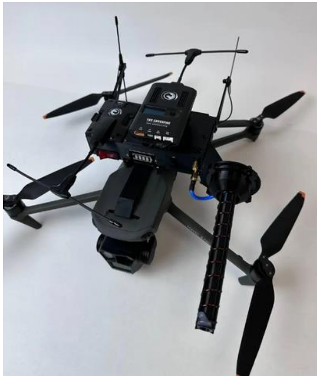
Рисунок 1.25 Ретранслятор для FPV дронів на DJI Mavic 3 українського виробництва [13]
