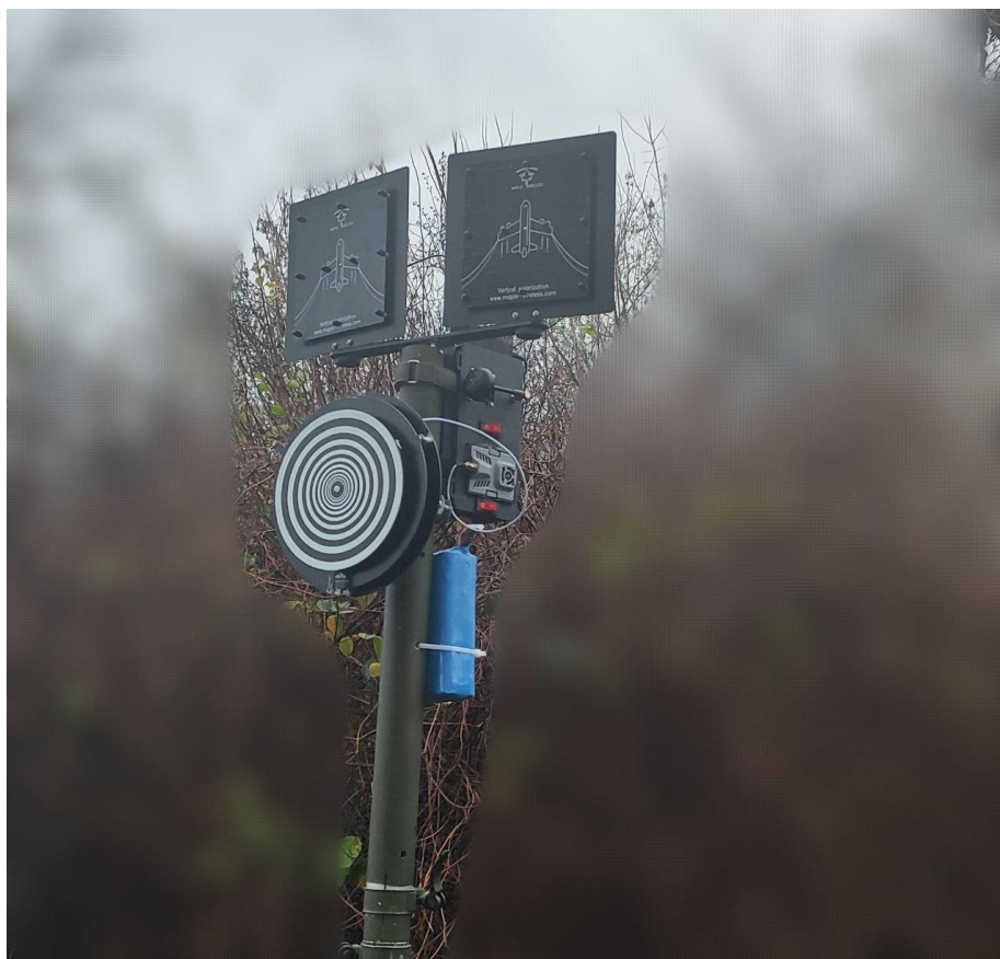
Рисунок 1.21 Наземний ретранслятор на прийом та передачу відеосигналу та сигналу управління для FPV дронів
