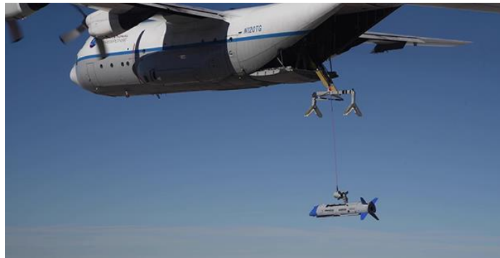
Рисунок 1.10 Десантуванням літального апарату Gremlin на C-130
