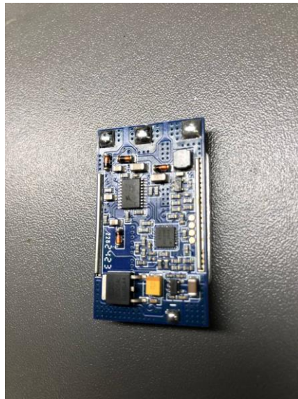
Рисунок 2.19 Підготовлений регулятор обертів з іншої сторони
