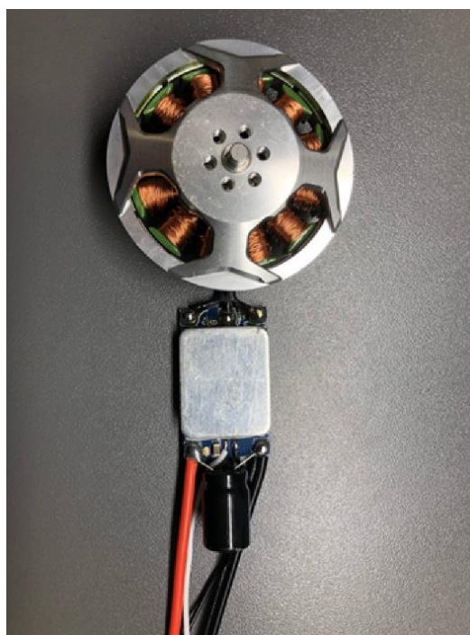
Рисунок 2.24 З'єднання мотору з регулятором обертів
