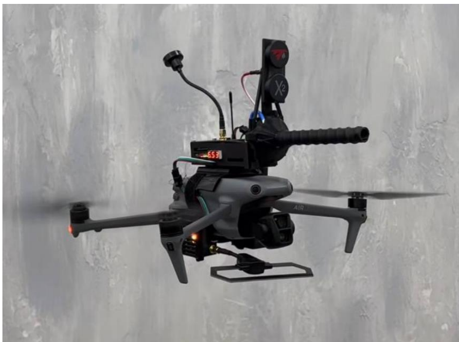
Рисунок 1.22 Ретранслятор для FPV дронів на DJI Mavic 3 українського виробництва [13]
