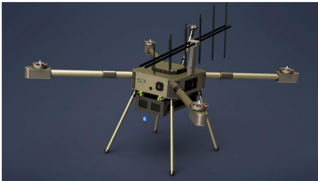
Рисунок 1.26 Комплекс БПЛА “Скіф”, призначений для ретрансляції радіо- та відеосигналу всіх видів безпілотних систем, українського виробництва [17]
