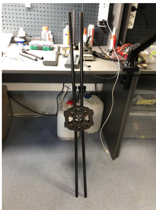
Рисунок 2.31 Демонстрація можливості складання рами БПЛА
