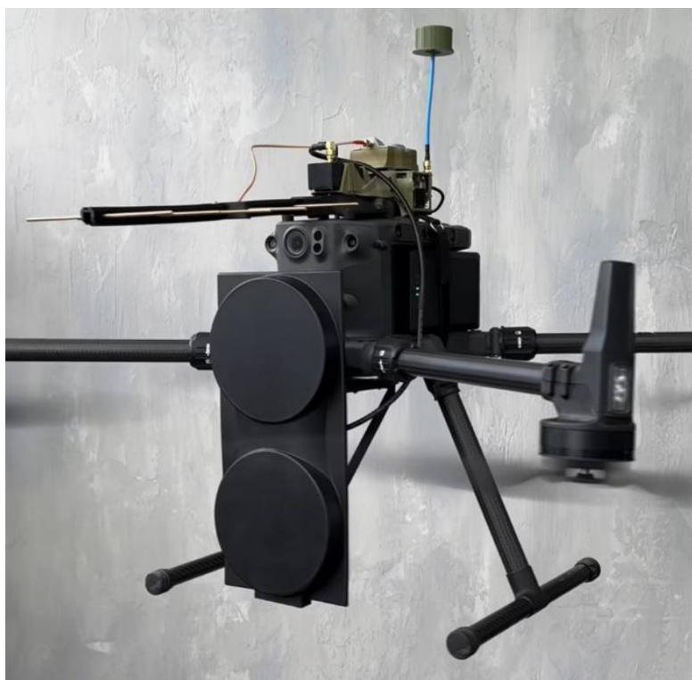
Рисунок 1.24 Ретранслятор для FPV дронів на DJI Matrice 300 українського виробництва [13]
