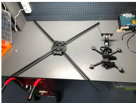
Рисунок 2.30 Порівняння рами БПЛА та 7-ми дюймового дрону
