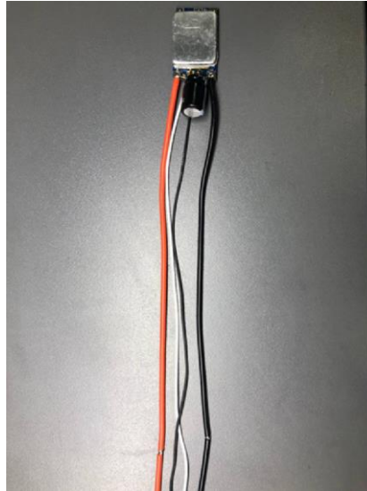
Рисунок 2.21 Підготовлення місця для конденсатора за 20 см від регулятора обертів
