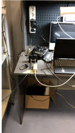
Рисунок 3.4 Змінний антенюатор для створення штучного затухання радіозв'язку
