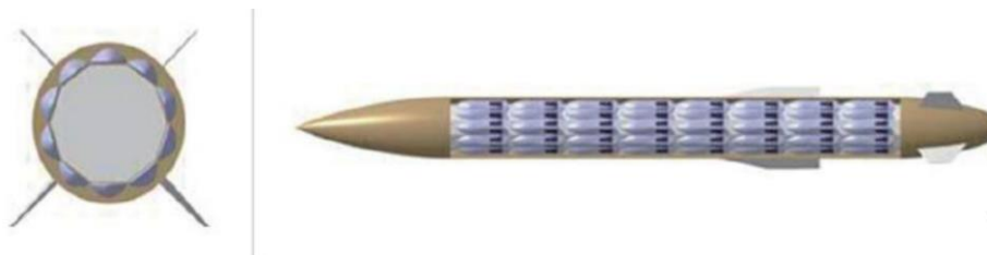
Рисунок 1.13 Форма та внутрішнє розташування ракетного носія
