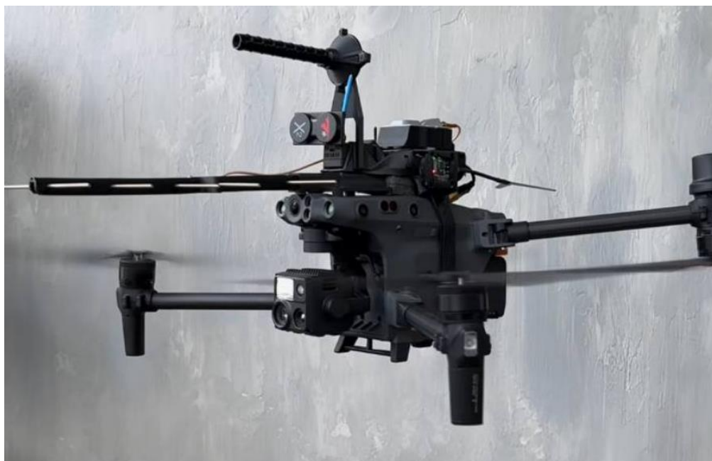
Рисунок 1.23 Ретранслятор для FPV дронів на DJI Matrice 30T українського виробництва [13]
