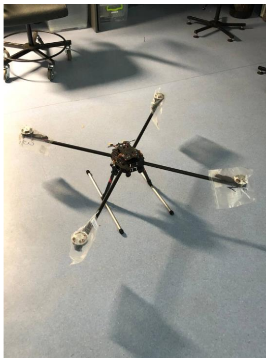
Рисунок 2.34 Демонстрація ББПЛА без закритого корпусу та з стандартними шасі
