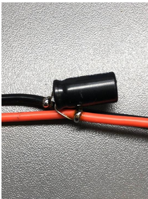
Рисунок 2.25 Встановлення додаткових конденсаторів по всій довжині кабелю
