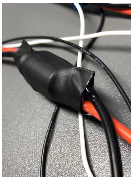
Рисунок 2.28 Ізоляція місця пайки силіконом
