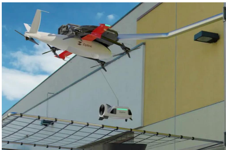
Рисунок 1.16 Нові дрони Zipline випускають приєднані міні-дрони для точної доставки пакунків
