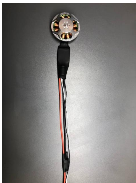
Рисунок 2.26 Закриття місць паяння термоусадкою
