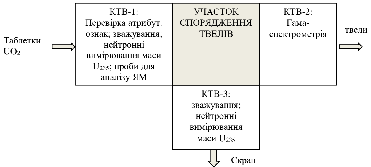
Рисунок 6.2. – Вимірювання різних форм ЯМ у ключових точках для ділянки спорядження твелів у виробництві палива АЕС
