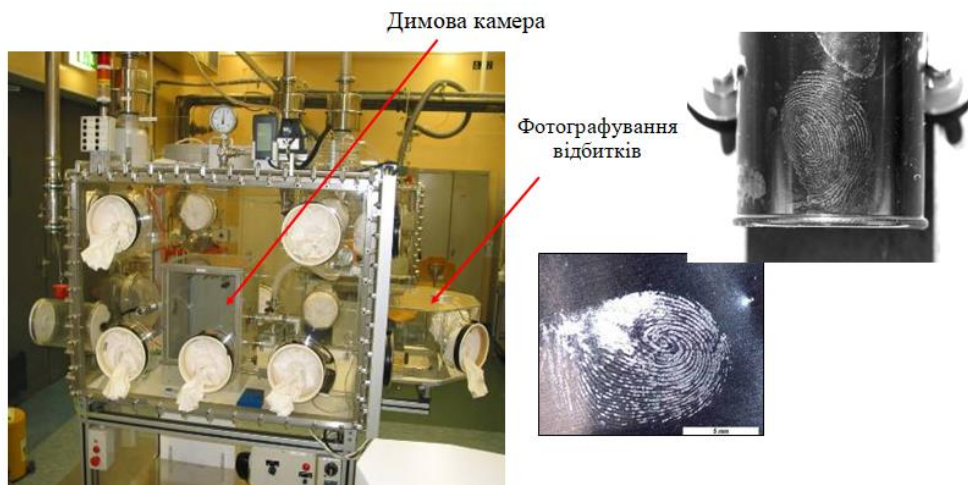
Рисунок 15.2. Бокс для зняття відбитків пальців (ціаноакриловий метод)
