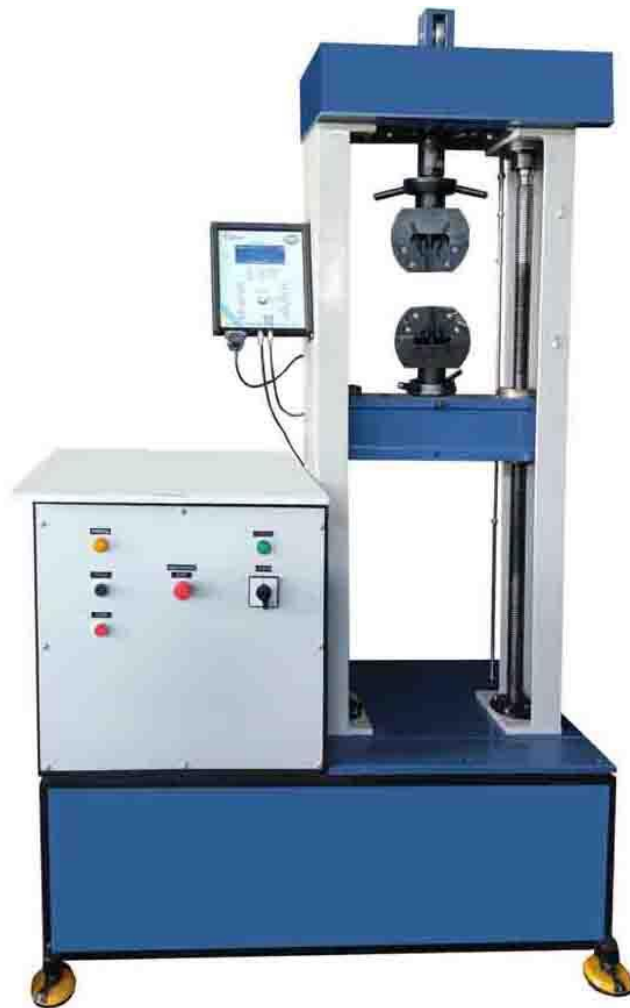
Рис. 4.1. Розривна машина Р-5М2.
