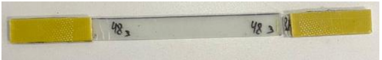
Рис. 4.3. Зразок склотканини 48 г/м 2 після випробування.
