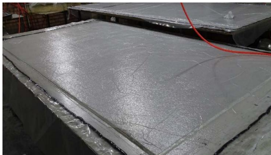
Рис. 1.22. Формування композитного листа. [11]
