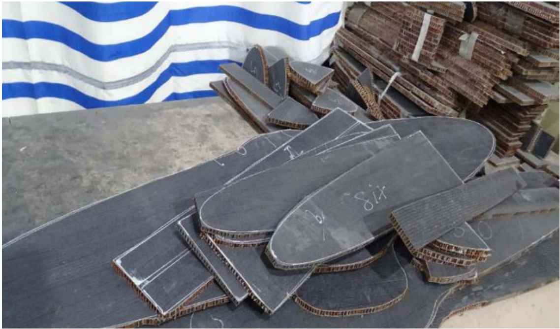
Рис. 1.23. Деталі, що виготовлені методом фрезерування з композитного листа.
