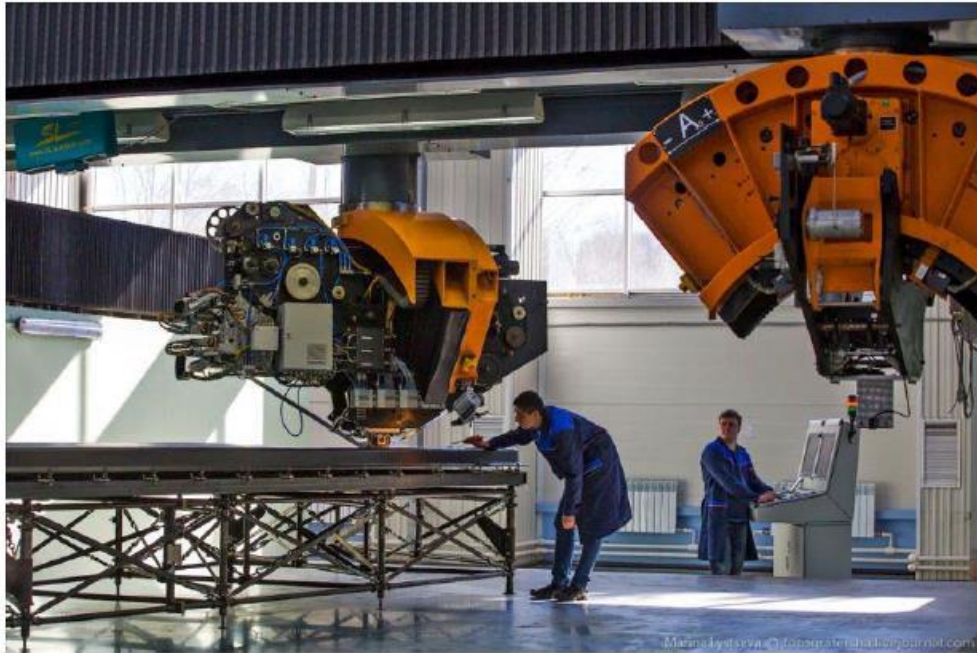
Рис. 1.20. Автоматизований пристрій для викладки композиту.
