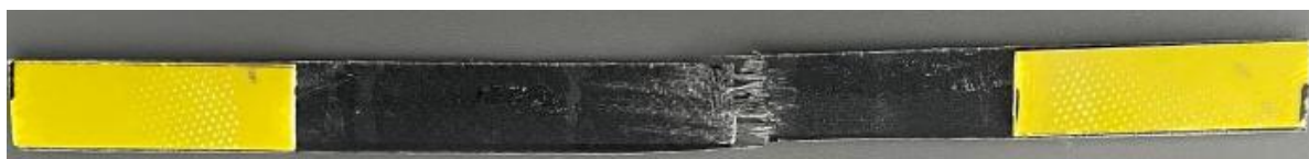
Рис. 4.16. Зразок вуглецевої тканини 80 г/м 2 після випробування.
