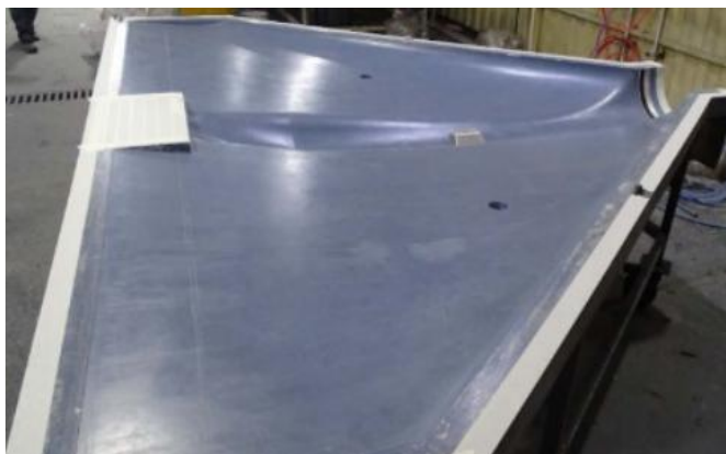
Рис. 1.18. Композитна матриця для виготовлення обшивки БПЛА. [11]
