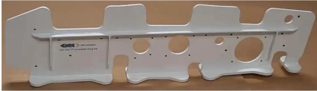
Рис. 1.17. Нервюра крила літака, що виготовлена з термопластичного композиту.
