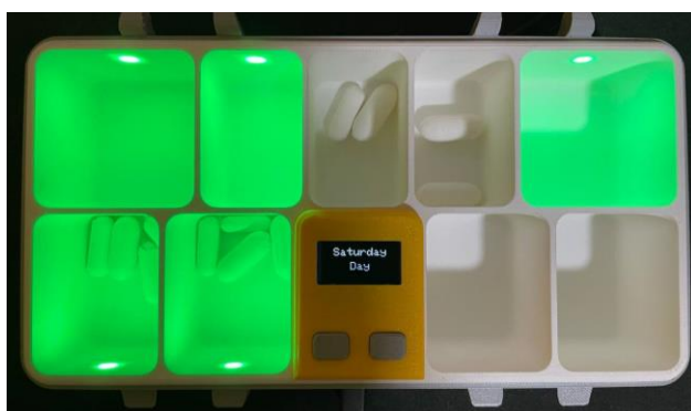
Рисунок 5.4 — Вивід збереженого графіка на OLED-дисплеї.
