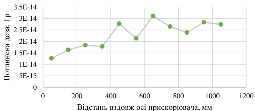
Рисунок 4.16 – Поглинена доза за рахунок \gamma -квантів без розсіювачів та конверсійної мішені
