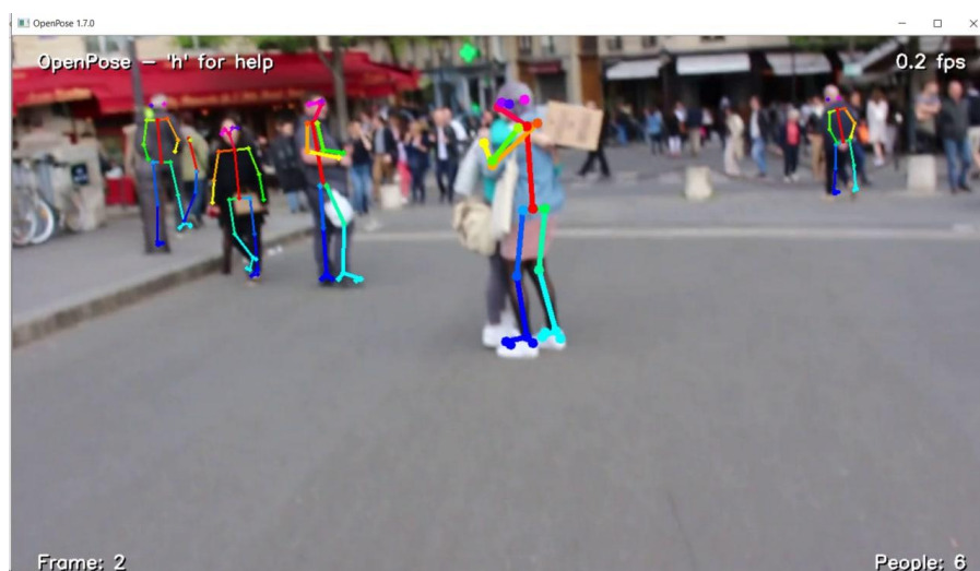
Рис. 3.5. Розпізнавання фігур і побудова графічного розташування розпізнаних частин тіла з відеозапису.
