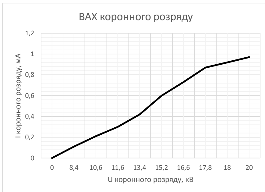
Рис. 2.23. Вольт-амперна характеристика коронного розряду на іонізаторі електростатичного фільтру.
