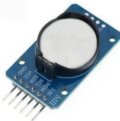
Рис.2.27 Модуль DS1307 годинник реального часу
